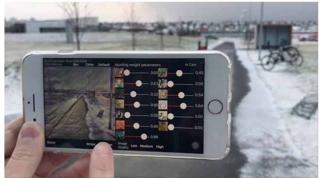
図6 multi-style feed-forward network を用いたアプリの動作例。画面右側のスライダーを動かすことで任意の重みでスタイルを合成し、リアルタイムに変換可能である。
