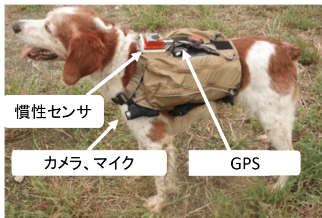
図1 大野らによって開発されたサイバースーツ
